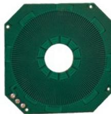
**2.2kW ECM PCB Stator**
